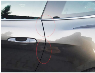
Spaltmasse aller Fahrzeugtüren (zwingend Textinfo, ob Spaltmasse verändert)
