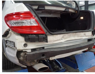
Detailaufnahme der Beschädigung ohne Verkleidung
